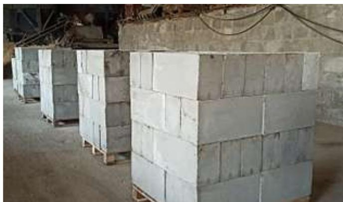
Пенобетонные блоки (Пеноблок): 600-300-200 мм / 400-300-200 мм / 600-300-100 мм
